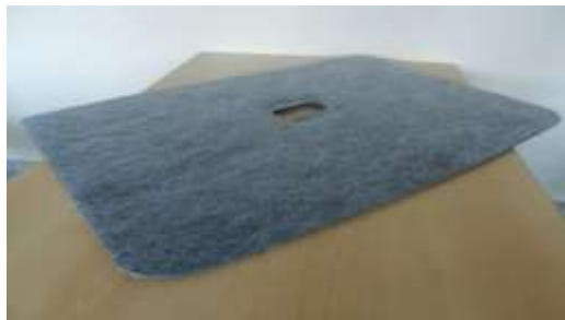
Roof Liner layer
